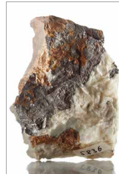
Abb. 2: Bleiglanz aus Scharnitz / Österreich; Länge 8 cm, Breite 6 cm, Höhe 2,5 cm (Foto: T. HARTMANN, JGU Mainz).
