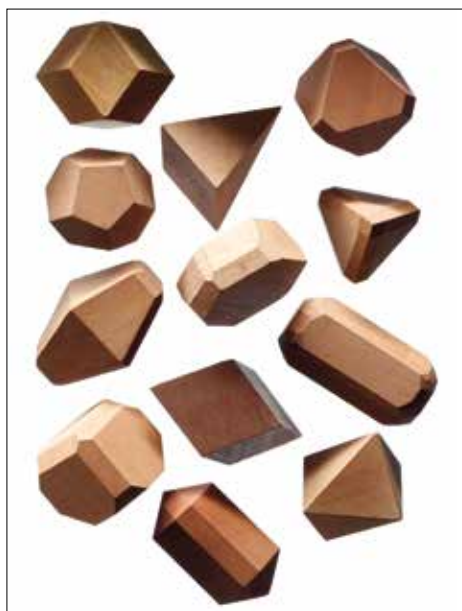
Abb. 7: Holzklötzchen zur Bestimmung der Kristallsysteme; je ca. 6 cm (Foto: T. HARTMANN, JGU Mainz).
