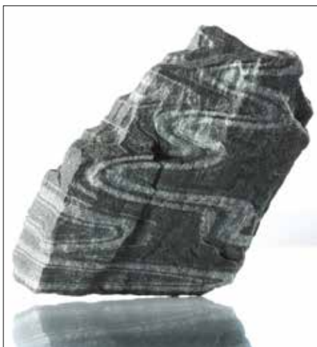
Abb. 1: Magnetit-Itabirite aus Sydvaranger / Norwegen; Länge 14 cm, Breite 8 cm und Höhe 3 cm (Foto: T. HARTMANN, JGU Mainz).
